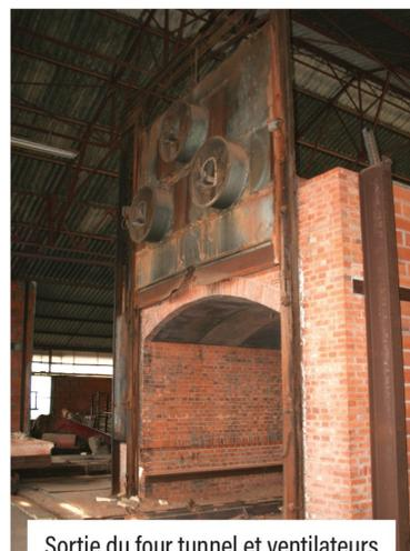
Sortie du four tunnel et ventilateurs
